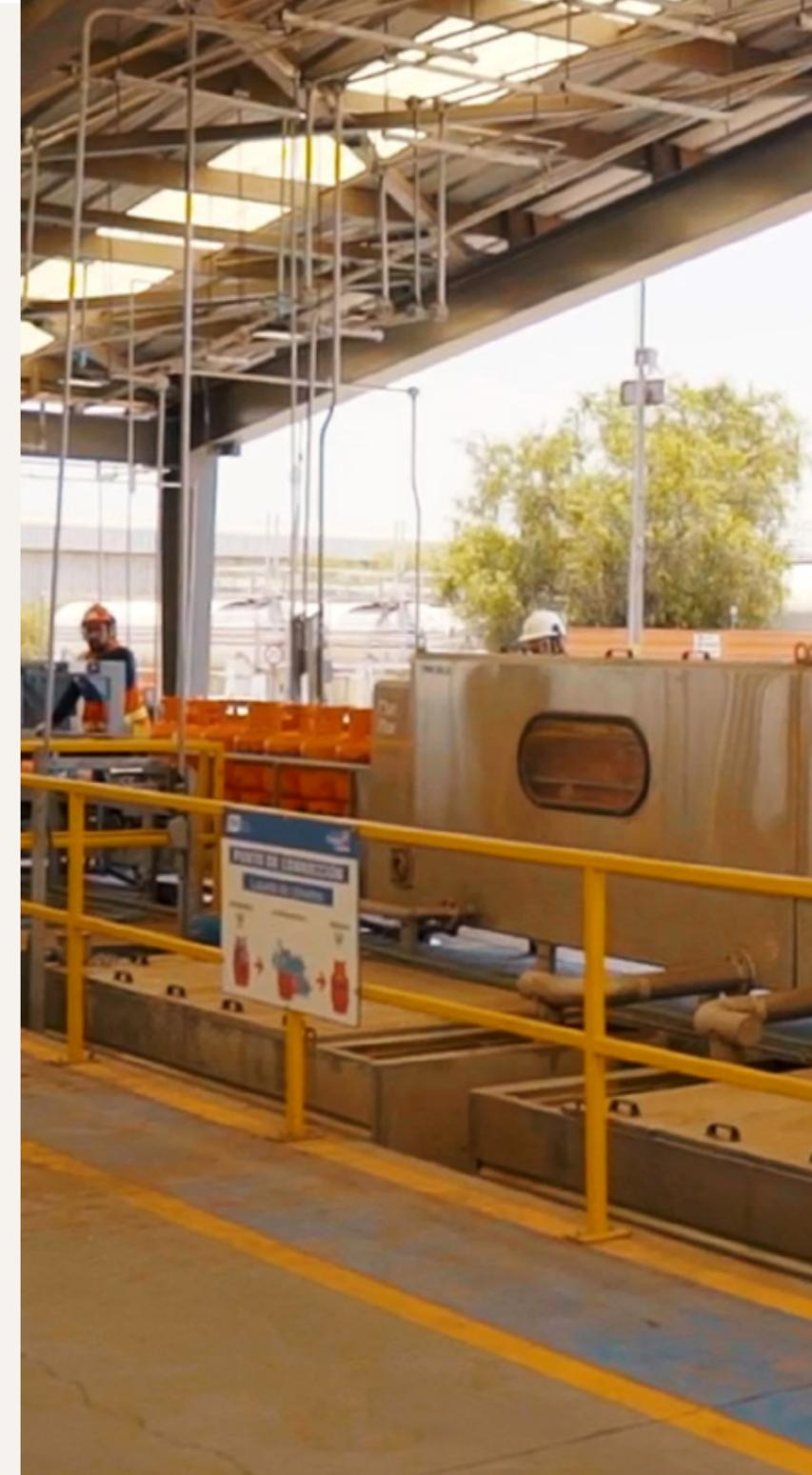
Máquina automática de lavado de cilindro »
